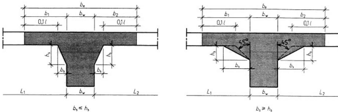
Figuur 15 – T-balken met afschuining
